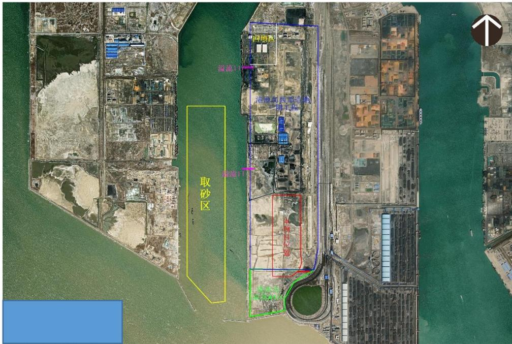
图 2.3-2 填海造地分区及取砂区示意图
